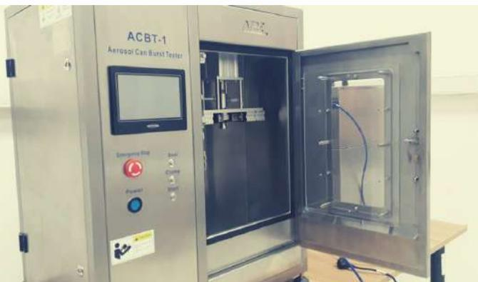
L'appareil de test de pression, permet de mesurer la résistance à la pression des générateurs des aérosols pour les déodorants, les désodorisants,... etc.
